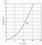
Abb. 1. Einfluss der Strömungsgeschwindigkeit von Luft auf deren Dichte o (20°C, 1 ata)
