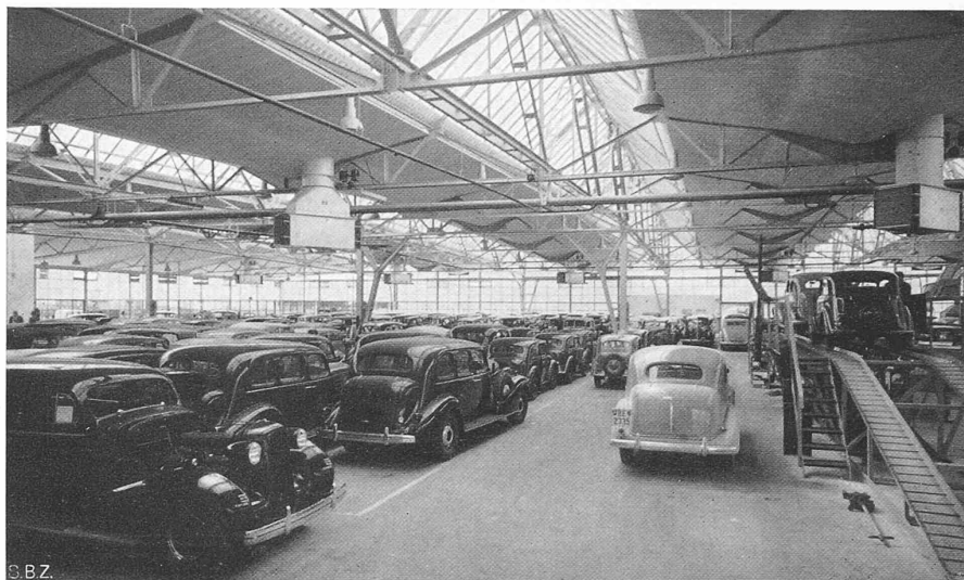
Abb. 18. Das Lager fertiger Wagen. Rechts «Nachregulieren von Bremsen und Motor», vergleiche Schema Abb. 13
