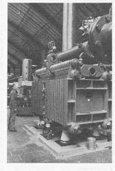
Grosser Wert wird darauf gelegt, dass die Plattierungen den Beanspruchungen durch Biegung, Torsion usw. nach Möglichkeit standhalten. Auf diese Weise konnten Grossapparate aus Eisen und Stahl hergestellt werden, deren Innenseite mit Kupfer plattiert, den chemischen Angriffen ebensogut wiedersteht, als wenn der Apparat aus massivem Kupferblech erstellt worden wäre.
