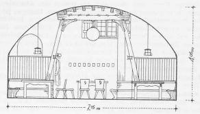
Abb. 1. Querschnitt 1:100 des Bier-Luftschutzkellers.
