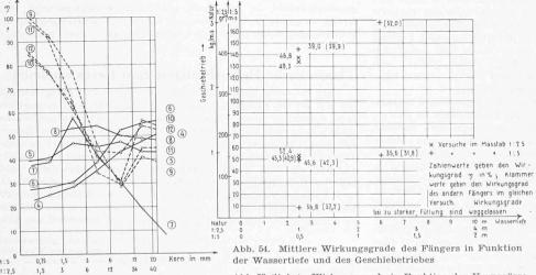
Abb. 53 (links). Wirkungsgrade in Funktion der Korngrösse
