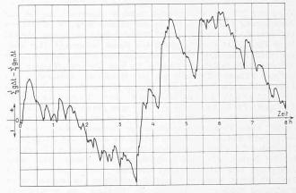
Abb. 49. Zeitlicher Verlauf der Geschiebefracht während 8 Stunden
