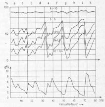
Abb. 50. Geschiebetrieb und Analysen in zweistünd. Mitteln, während 80 Stunden
