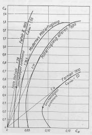
Abb. 5. Auftriebkoeffizient Ca in Funktion des Widerstandskoeffizienten Cw: Verbesserung der Gleitzahl durch Verminderung der schädlichen und induzierten Widerstände.
