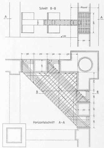
Abb. 20. Provisor. Eckaussteifung zur Sicherung der Minarette. - 1:160
