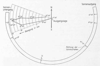
Abb. 22. Gemessene Horizontalbewegung eines Minaret in Höhe seiner obern Plattform (63,70 m über Boden), infolge Sonnenbestrahlung. Die Gesamthöhe über Boden ist 82,0 m, davon 57,3 m freistehend mit max. Schaftstärke im Achtkant von 3,0 m
