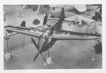
Abb. 4. Jagd-Einsitzer Koolhoven FK 55 von 1936. 860 PS-Motor im Flugzeugschwerpunkt, gegenläufige Propeller, Spannweite 9 m, Länge 8,4 m, Tara 1200 kg, Brutto 1800 kg, v in 4400 m Höhe 450 km/h.
