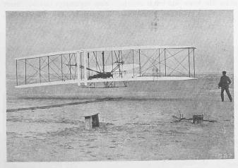
Abb. 3. Erster Motorflug von Orville Wright in Kitty Hawk am. 17. Dez. 1903. Flugweite rd. 260 m, Doppeldecker von 46 m², 12 PS-Motor, Flugzeuggewicht 400 kg, erreichte Geschwindigkeit rd. 50 km/h.
