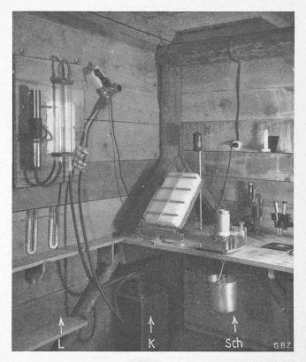
Abb. 5. Apparate zur Prüfung der Luftdurchlässigkeit (L), des Kriechens (K) und kleiner Scherapparat (Sch)
