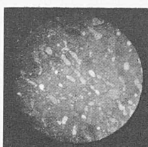
Abb. 4. Schneedünnschliff mit gericht. Eiskristallen nach Scherbeanspruchung
