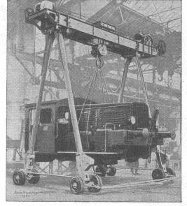
Mittelschwere Type, bis 30 t Tragfähigkeit
