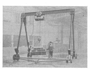
Leichte Type, bis 5 t Tragkraft
