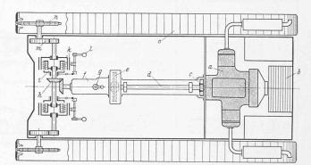
Abb. 7. Antrieb des deutschen Maschinengewehr-Panzerkampfwagens. a Motor, b Oelkühler, c Hauptvorgelege, d Zwischenwelle, e Hauptkupplung, f Schaltgetriebe, g Schalthebel, h Kegeltrieb, i Lenkkupplungen, k Kupplungsbremsen, l Lenkhebel, m Seitenvorgelege, n Triebrad, o Raupe
