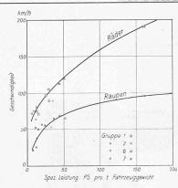
Abb. 9. Erzielbare Geschwindigkeit für geländegängige Fahrzeuge in Abhängigkeit von der spezif. Leistung (nach Angaben in Heigls Taschenbuch der Tanks)
