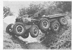
Abb. 1 bis 3. Geländegängiger Saurer-Wagen (Prototyp) im Gelände. Text siehe Seite 75
