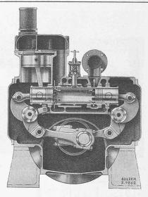
Abb. 1. Sulzer-Kleindieselmotor, 1500 U/min
