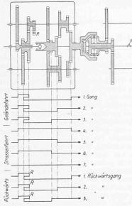
Abb. 8. Getriebe mit 10 Gängen
