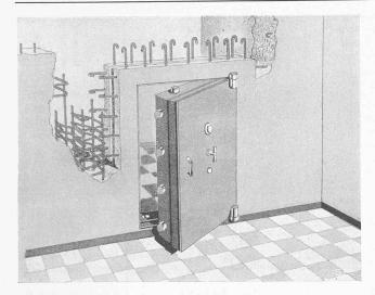
ein in einer Nute liegender Gummischlauch. Guckloch und Spülloch sind als Aussparungen im Beton der Türe vorgesehen. Die Vorteile der Eisenbeton-Gasschleusentüre gegenüber Eisentüren sind: Beständigkeit, Unempfindlichkeit gegen die Witterungseinflüsse, kein Anstrich notwendig; Feuerbeständigkeit, kein Werfen; Schmelzsicherheit gegen Thermit, grösste Gasdichtigkeit. Für ganze Schutzräume (Abb. 2) sind die Vorteile des Systems gegenüber eisernen Konstruktionen folgende: bauliche Verein-
