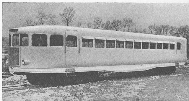
Abb. 4. Meterspur-«Micheline» mit Benzinmotor; 46 Sitzplätze
