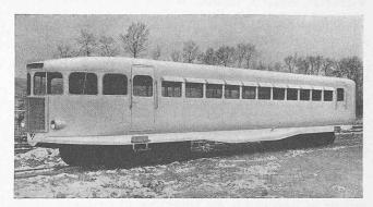
Abb. 4. Meterspur-«Micheline» mit Benzinmotor; 46 Sitzplätze
