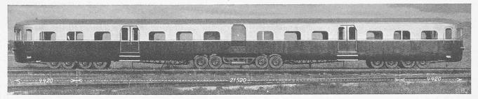
Abb. 2. Normalspur-«Micheline», 400 PS-Benzinmotor im mittl. Drehgestell; Kastenlänge 30,36 m; 96 Sitze, 40 Stehplätze; Tara 19 t; Vmax 130 km/h
