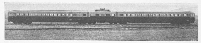
Abb. 3. Normalspur-«Micheline» auf vier Drehgestellen, zwei Benzinmotoren; 106 Sitzplätze, Tara 25 t, Sitzplatzgewicht 235 kg
