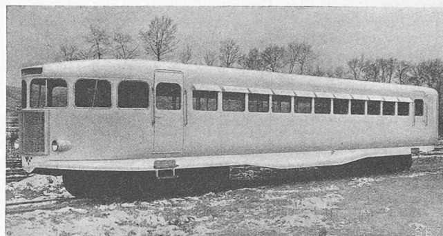
Abb. 4. Meterspur-«Micheline» mit Benzinmotor; 46 Sitzplätze
