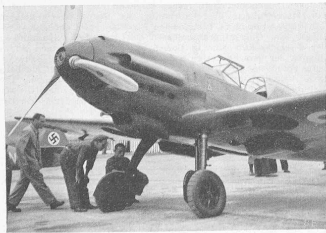
Abb. 2. Messerschmitt, 950 PS, V &gt; 500 km/h, einklappbares Fahrgestell
