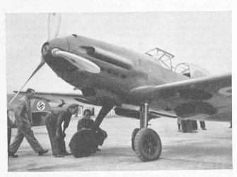
Abb. 2. Messerschmitt, 950 PS, V > 500 km/h, einklappbares Fahrgestell
