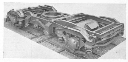
Abb. 2. Liechty-Lenkdrehgestell mit 3400 mm Radstand, erbaut von der S. I. G. Neuhausen
