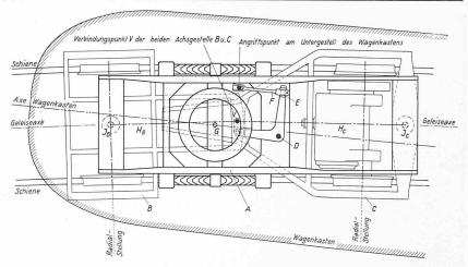
Abb. 1. Schema 1:50 des Drehgestells mit gesteuerten Achsen System Liechty
