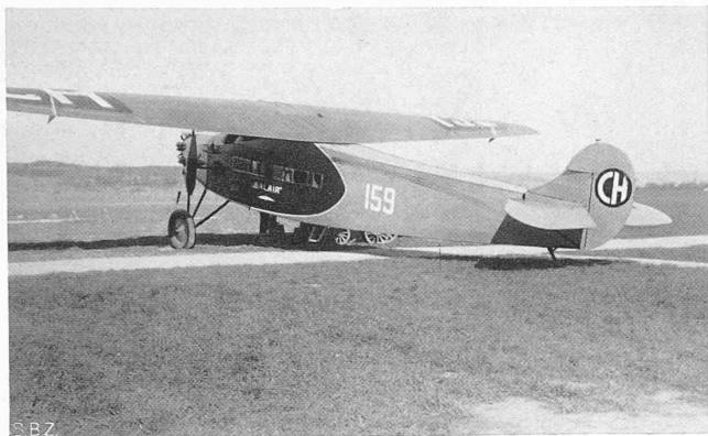
Abb. 3. Einmotoriger Fokker F VII der «Balair»; 8 Plätze
