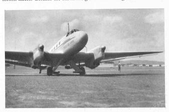
Abb. 8. Zweimotoriger Junkers Ju86 mit Dieselmotoren; 10 Plätze 1936
