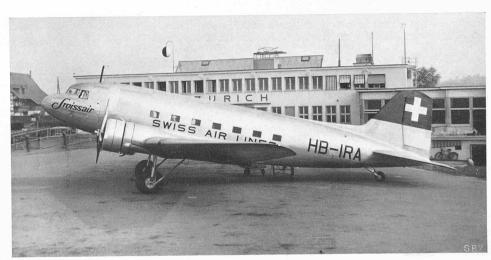
Abb. 9. 21-plätziger Douglas DC3 der «Swissair».  $2\times1000$  PS, Reisegeschwindigkeit bis 290 km/h
