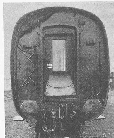
Abb. 2. Stirnansicht Kastenbreite 2,943 m, Höhe 3,945 m über S. O.
