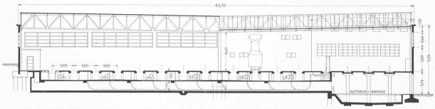
Abb. 3. Querschnitt durch die Strassenbahn-Wagenhalle Oerlikon. — Masstab 1:400
