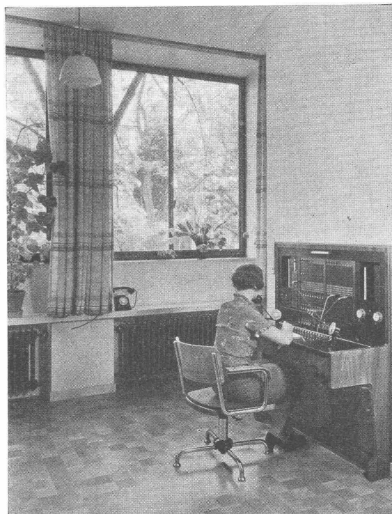
Vermittlerschrank für 10 Amtsleitungen
