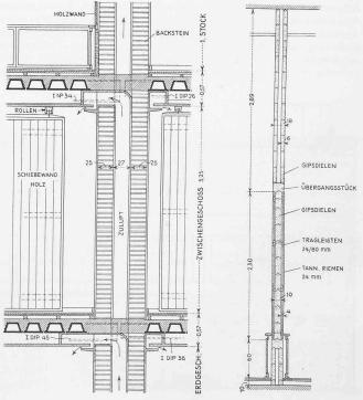
Abb. 5. Decken und innere Tragwand, rechts Zwischenwand. -1:60.
