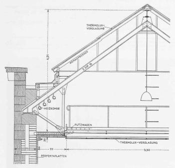
Abb. 7. Normale Oberlicht-Konstruktion, 1:60.
