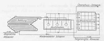
Abb. 7. Schema der Teilreinigung mittels Belebtschlamm in Birmingham (England).
