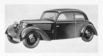
Abb. 3. DKW-Front, 3,5 St.-PS, 2 Zyl. 2 Takt, Vorderrad-Antr., Vmax 85 km/h.
