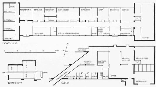
Abb. 13. Grundrisse und Querschnitt des Pathologischen Institutes.
