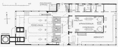
Abb. 3. Erdgeschoss des Fernheizgebäudes. — Masstab 1:400.
