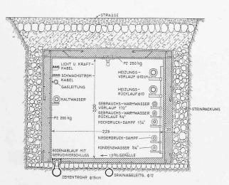
Abb. 7. Querschnitt des Verkehrstunnels. Masstab 1:50.
