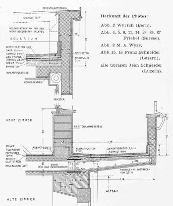
Abb. 35. Einzelheit der Aufstockung. — Masstab 1:30.
