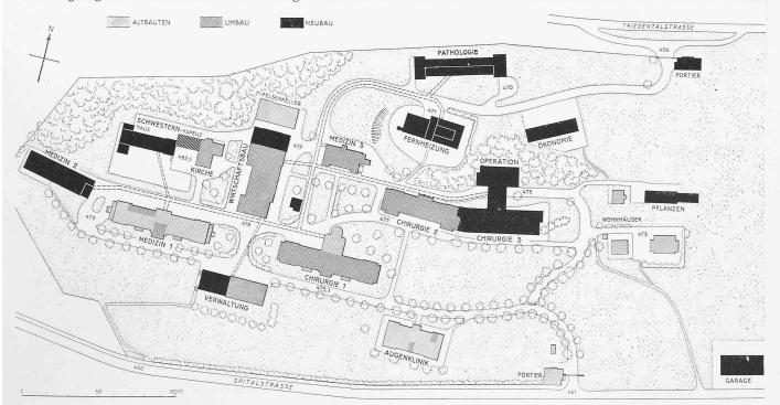
Abb. 1. Lageplan der Kant. Krankenanstalt Luzern. Masstab 1:2500, Höhen in m ü. M. Gestrichelt sind die alle Bauten verbindenden unterirdischen Gänge («Verkehrstunnel») zum Transport von Kranken, Wäsche, Speisen usw.
