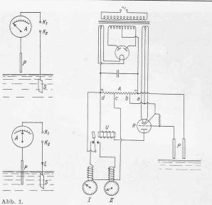
Abb. 2. A Ampèremeter, P Pegel, S Tauchplatte, K<sub>1</sub> K<sub>2</sub> Anschlussklemmen.
