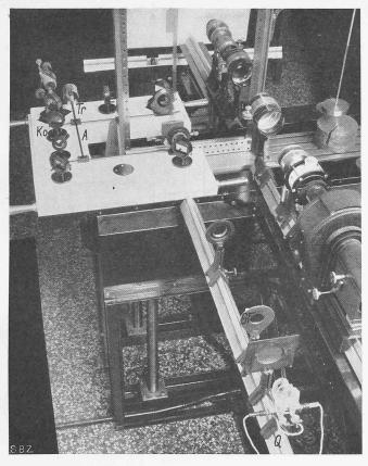
Abb. 6. Optisches Interferometer für photoelastische Messungen.
