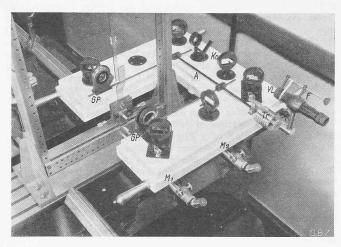
Abb. 7. Optisches Interferometer für photoelastische Messungen.
