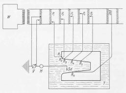
Abb. 5. Elektrisches Schaltschema für die Messung von  $\sigma_1+\sigma_2$ .
