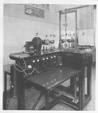
Abb. 1. Gesamtansicht der photoelastischen Messapparatur.
