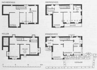
Abb. 13. Grundrisse zum Hause Meinherz. — Masstab 1:400.
