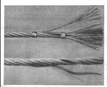
Oben: Drahtseil 15 mm Ø, 222 × 0,7 mm, verzinkter Stahldraht mit 180 bis 200 kg/mm² Bruchfestigkeit, n i cht vorgeformt.
