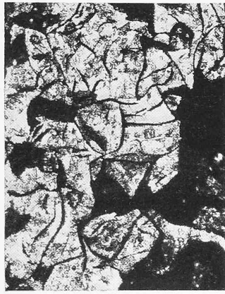
Abb. 9. Gusseisen nach 10 min Beanspruchung. Die Graphitplättchen und -Nester sind herausgespült. Die schlecht verbundenen Eisenteilchen werden abgesprengt.
