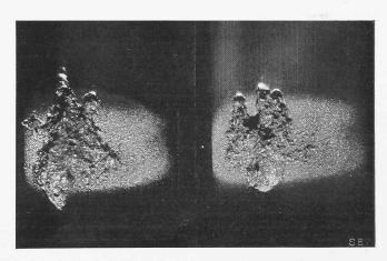
Abb. 5. Anfressungen an 5% -Ni-Stählen verschiedener Wärmebehandlung nach 3 Stunden Beanspruchungszeit. Teilweise hat sich das Wasser unter der Metalloberfläche einen Weg gebahnt, was auf eine explosionsartige Wirkung der Wasserschläge in den Ecken der Löcher schliessen lässt.
