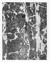
Abb. 10. Anfressungsanfang (10 min Beanspruchung) an stark verschlacktem Stahl. Die im Ferrit eingebetteten Schlacken sind herausgeschlagen, mit ihnen Teile des Ferrits. Die Anfressung hat eingesetzt; ihr fällt zuerst der verungenigte Ferrit und
