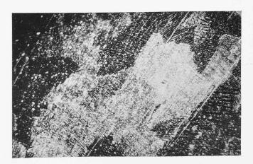
Ausschnitt aus der Beanspruchungsfläche einer nur geschliffenen Probe. Das Reflexionsvermögen des hell hervortretenden, mittlern Kornes ist durch die starke Aufrauhung erhöht. Im rechten obern Teil des Kornes hat die Anfressung, die in Form und Lage einem Aetzgrübchen ähnelt, eingesetzt. Vergrösserung 18-fach.
