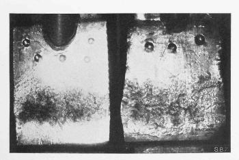
Abb. 4. Verformung der Beanspruchungsflächen von zwei verschieden harten Al-Ni-Bronzen nach 20 min Versuchsdauer. Besonders die rechte, weichere Probe wurde vom Wasserschlag stark ausgebeult. Vergrösserung 2,4-fach.
