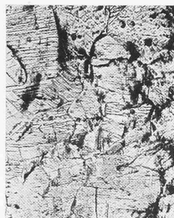
Abb. 1. Ms 63 nach 10 min Beanspruchungsdauer. Abb. 2. 25% Ni-Stahl. Abb. 3. Neusilber. Randzonen der Beanspruchungsfläche.
