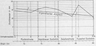
Abb. 24. Verlauf des massgebenden Korndurchmessers, ermittelt aus dem Geschiebemischungsband.
