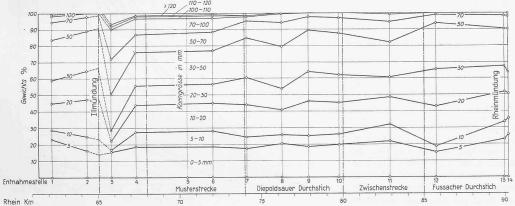
Abb. 23. Geschiebemischungsband für den Rhein von der Illmündung bis zum Bodensee. (Mitgeteilt von der Rheinbauleitung Bregenz.)
