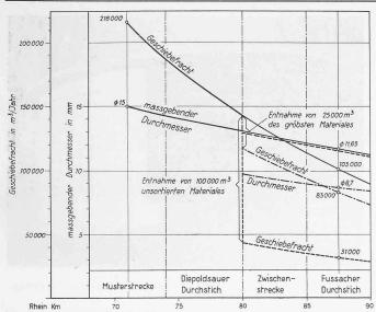
Abb. 31. Geschiebe-Frachtverlauf und Verlauf des massgebenden Ø.
