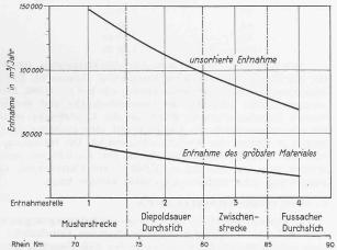
Abb. 32. Baggermenge in Funktion des Entnahmeorts und der Entnahmeart.
