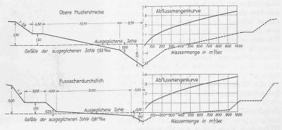
Abb. 20. Massgebende-Profile und Abflussmengenkurven der beiden Musterstrecken.
