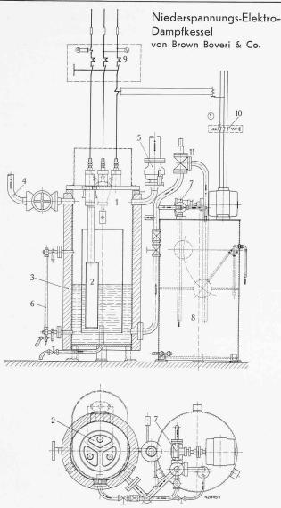
Abb. 5. Schnitt durch den BBC-Niederspannungs-Dampfkessel mit Tauchelektroden. 1 Elektrokessel, 2 Elektroden, 3 Thermische Isolation, 4 Dampfaustritt, 5 Sicherheitsventil, 6 Wasserstandzeiger, 7 Speisepumpe, 8 Speisewasserbehälter, 9 Oelschalter mit Volt- und Ampèremeter, 10 Oelschalter mit Magnetbetätigung zur Leistungsbegrenzung, 11 Ueberströmventil.
