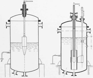
Abb. 1. Primitive Bauart eines einpoligen Elektrodenkessels. Leistungsregulierung durch Verminderung des Wasserstandes.
