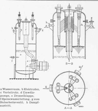
Abb. 3. Schnitt durch den BBC-Wasserstrahl-Hochspannungs-Elektrodenkessel. [Abb. 3 und 5 Bildstöcke von BBC.]
