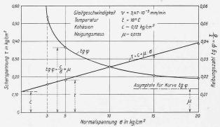
Abb. 9. Beziehungen zwischen Scherspannung  $\tau$ , bezw. Reibungszahl tg  $\varphi$  u. Normalspannung  ${\tt G}$  für t konst. u. gegebene Gleitgeschwindigk.
