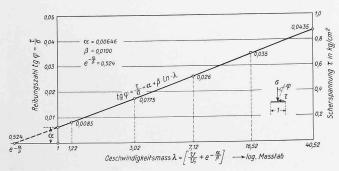
Abb. 8. Beziehungen zwischen Reibungszahl tg $\varphi$  und Gleitgeschwindigkeit v für  $\sigma=20~{
