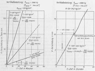
Abb. 6. Links kleine, rechts grosse Verschiebungen in Funktion der Zeit, bei  $18\,^{\circ}$  C.
