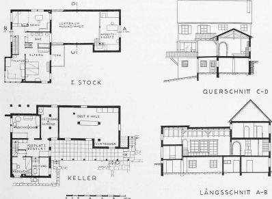
Abb. 10. Grundrisse und Schnitte vom Hause Arch. BSA K. Kündig. — 1:400.
