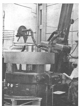
Maag-Zahnradschleifmaschine Typ HSS-4.
