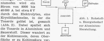
brennt, jenes sammelt sich auf dem negativen Ofenboden und wird von Zeit zu Zeit ohne Betriebsunterbruch abgestochen oder -geschöpft und in eisernen Formen zu Masseln gegossen. Zur Erzeugung von 1 kg Al sind etwa 24 kWh Gleichstrom nötig, für eine Jahresproduktion von 20000 t (Mittel 1926 bis 1930 in Chippis) also etwa 480 Mill. kWh — ein Bedarf, der (wie auch jener der Nebenbetriebe) in Chippis grösstenteils durch fünf eigene Kraftwerke gedeckt wird (vrgl. «SBZ» Bd. 58, S. 97\* ff.).
