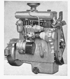
Abb. 1. Typ LCBD1 Saurer-Diesel-Chassis, 4 Zyl., 2,84 l, 14,5 Steuer-PS, Gewicht 1500 kg.
