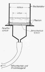
Abb. 2. Prüfung der Kapillarität durch die Bestimmung der Wasserdurchlässigkeit unter einem Wasserdruck von 0,96 kg/cm². Durchlassfläche 38,4 cm². Versuche an der EMPA.
