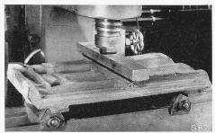
Prüfung von Dachziegeln auf Biegetragfähigkeit:
