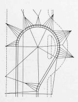
Abb. 11. Fahrleitungsschleifen: links in üblicher Bauart.
