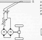
mit Brennstoffmotor. Das Herabziehen der Stromabnehmer geschieht mit Hülfe einer mechanischen Vorrichtung während der Fahrt. Heutige Wagenform wie in Abb. 5.
