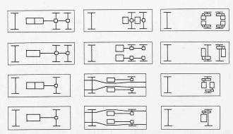
Abb. 6. Verschiedene Antriebsanordnungen für Trolleybusse.
