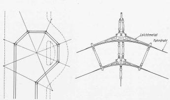
rechts Bauart Westinghouse-Holden mit wenigen Stützpunkten und Leichtmetall-Kurvenstücken.
