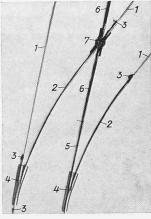
Abb. 13. Fahrleitungskurve und -Weiche mit stabilen Rohrbogenstücken Bauart Kummler & Matter (Aarau). 1 Fahrdraht; 2 Bogenstücke mit Uebergangsklemmen 3; 4 Weichen; 5 Verbindungsstück; 6 Stab-Isolatoren; 7 Kreuzungsstück.
