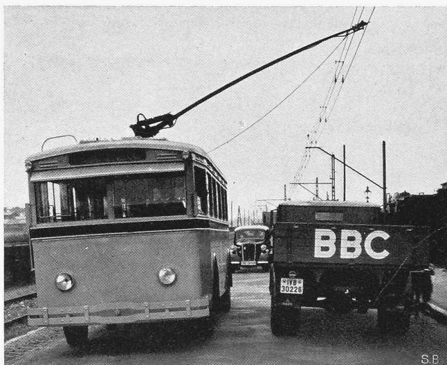
Abb. 14. Einstangen-Stromabnehmer und Vielfach-Aufhängung BBC.
