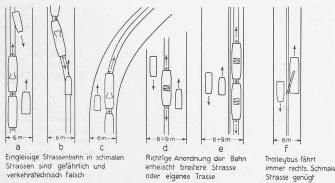
Abb. 3. Strassenbreiten für Strassenbahn und Trolleybus.
