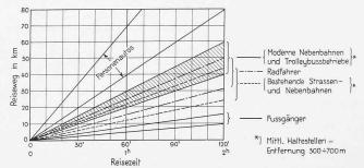
Abb. 4. Vergleich der Reisegeschwindigkeiten verschied. Verkehrsmittel.
