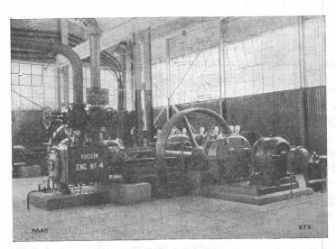
MAAG-Getriebe zwischen Elektro-Motor und Kolbenkompressor in einer Oel-Raffinerie am persischen Golf. Umgebende Temperatur bis 70 ° C. Total 30 MAAG-Getriebe für diese Raffinerie geliefert.
