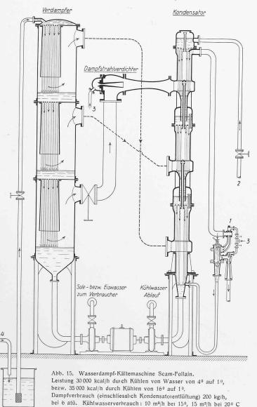
Eintritt-Temperatur des Wassers. LEGENDE: 1 Zweistufiger Dampfstrahlverdichter mit Zwischenkondensation für Luftabsaugung, 2 Kühlwasser-Zutritt, 3 Frischdampf-Zutritt, 4 Sole-Rücklauf vom Verbraucher.
