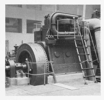
Abb. 6,  $\,$  450 PS  $\,$ 3 Zylınder 4 Takt-Dieselmotor mit Büchi-Aufladung der Schweiz. Lokomotiv- und Maschinenfabrik Winterthur (SLM).
