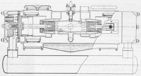
Abb. 8. Freitlugkolben-Motor-Kompressor (System Pescara) zur Erzeugung von Druckluft. — Masstab 1:10. Spielzahl 1000 in der Minute.
