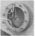
Abb. 4. Einbau der Thermodrähte im Dieselmotor-Kolben.
