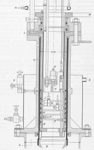
Abb. 10. Messeinrichtung für Kolbenring-Reibung. Masstab 1:6.
