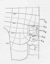
Abb. 5. Gemessene Temperaturtelder im Deckel, Zylinder und ölgekühlten Kolben, sowie im I. Kolbenring des Zweitakt-Dieselmotors bei Vollast. — Aus E. T. H. Diss. von K. Hug.
