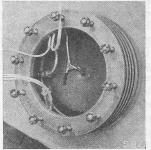
Abb. 4. Einbau der Thermodrähte im Dieselmotor-Kolben.
