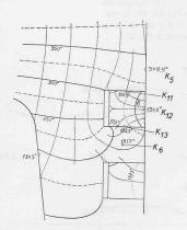
Abb. 5. Gemessene Temperaturtelder im Deckel, Zylinder und ölgekühlten Kolben, sowie im I. Kolbenring des Zweitakt-Dieselmotors bei Vollast. — Aus E. T. H. Diss. von K. Hug.
