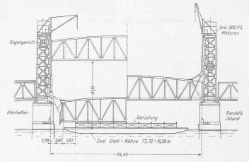
Abb. 5. Hubbrücke über den Harlem River. — Masstab 1:1500.
