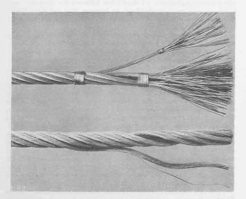
Abb. 1. Oben: Drahtseil 15 mm  $\oslash$ ,  $222 \times 0.7$  mm, verzinkter Stahldraht mit 180 bis 200 kg/mm² Bruchfestigkeit, *nicht* vorgeformt. Unten: Das selbe Seil in Machart «Tru-Lay-Brugg». Man erkennt deutlich die Vorformung des Einzeldrahtes und der Litze.
